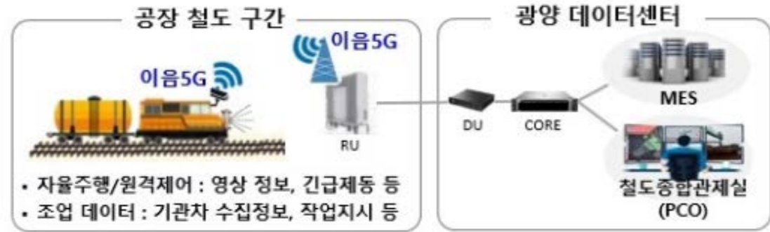
이음5G를 통한 구내운송 철도 자율주행 시스템 구성도 <포스코DX>
